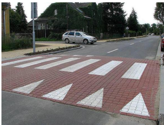
Obr. 22: Zvýšená plocha vozovky donutí řidiče zpomalit
